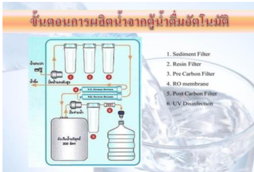
รูปที่ 5 รูปแบบขั้นตอนการผลิตน้ำจากตู้น้ำดื่มหยอดเหรียญ (ที่มา : กรมวิทยาศาสตร์การแพทย์ กระทรวงสาธารณสุข, 2562)
