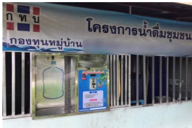
รูปที่ 2 ตู้น้ำดื่มหยอดเหรียญอัตโนมัติแบบมีหัวบรรจุติดตั้งอยู่ที่ผนังภายนอกอาคาร
